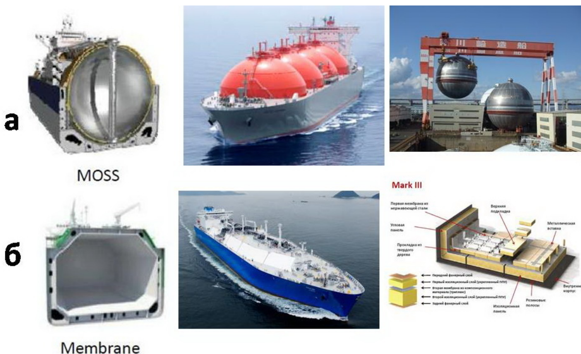
Рис. 4. Основные грузовые танки газовозов: а) Сферические танки типа Moss; б) Мембранные танки компании «GTT»
